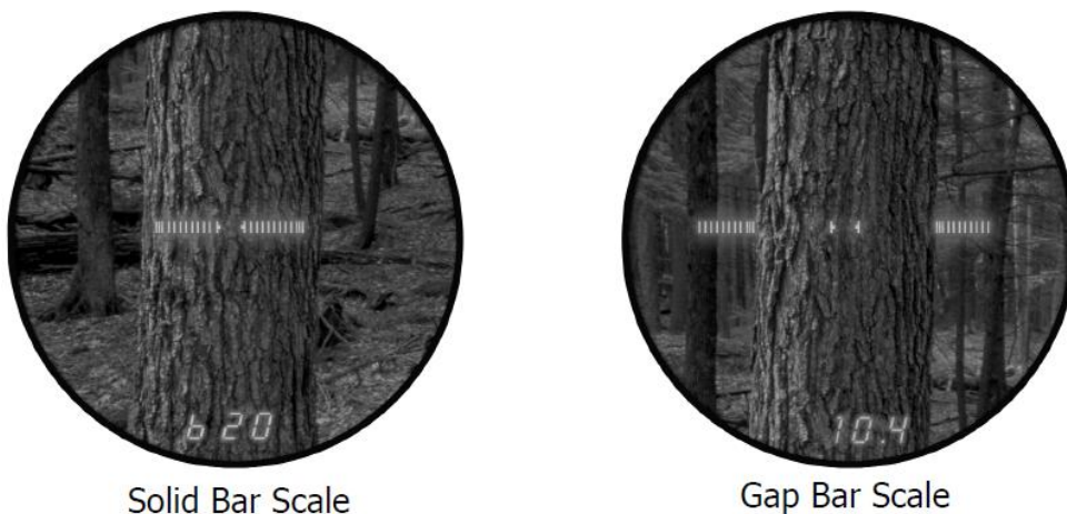
Figura 4. Modos de medição do Criterion RD 1000: Solid Bar Scale e Gap Bar Scale
