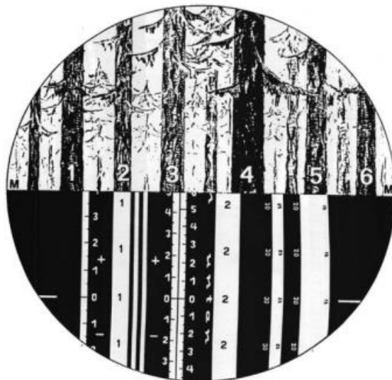
Figura 3: Porção da escala do Relascópio contida na metade inferior do campo visual e a metade superior na qual se observa a paisagem (BITTERLICH, 1984).
