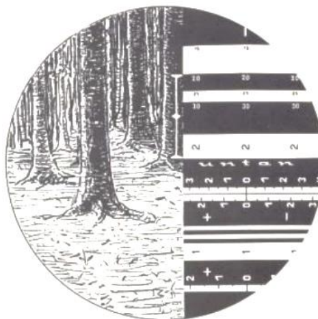
Figura 5: Vista geral das escalas quando se realiza uma mirada com o aparelho na posição horizontal a uma distância de 20 m da árvore com a mira.
