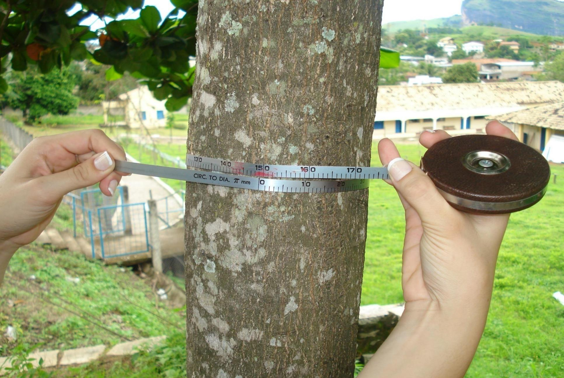
**Figura 5** – Medição do diâmetro com a fita diamétrica
