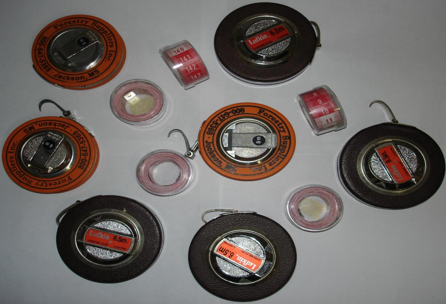
Figura 4 – Conjunto de fitas diamétricas e métricas
